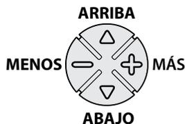
**Fije la hora actual** utilizando las llaves "PLUS" (más) y "MINUS" (menos). Sosteniendo la llave presionada, la hora cambiará rápidamente. Un golpecito causará un cambio escalonado. Una vez que haya fijado la hora correcta, utilice la llave de la flecha hacia abajo para moverse a la sección siguiente.
